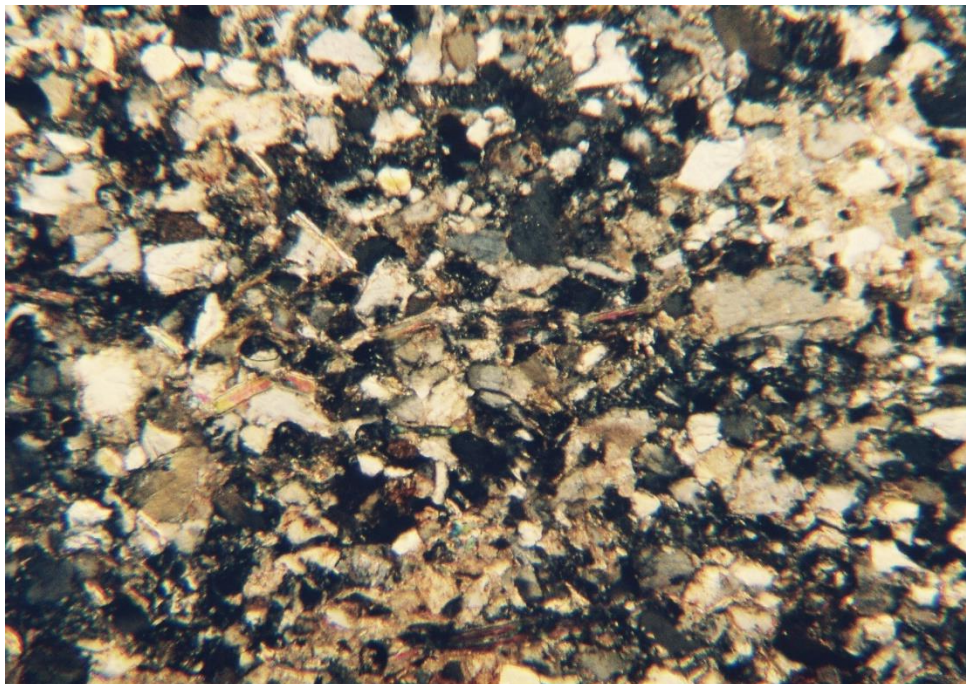
Pískovec křemenný, prachovitý, slídnatý, hematitizovaný vzorek ČB–1, městské opevnění, zvětšení 32x, nikoly X, struktura „čistého“ křemenného pískovce, kalifikace ZH
