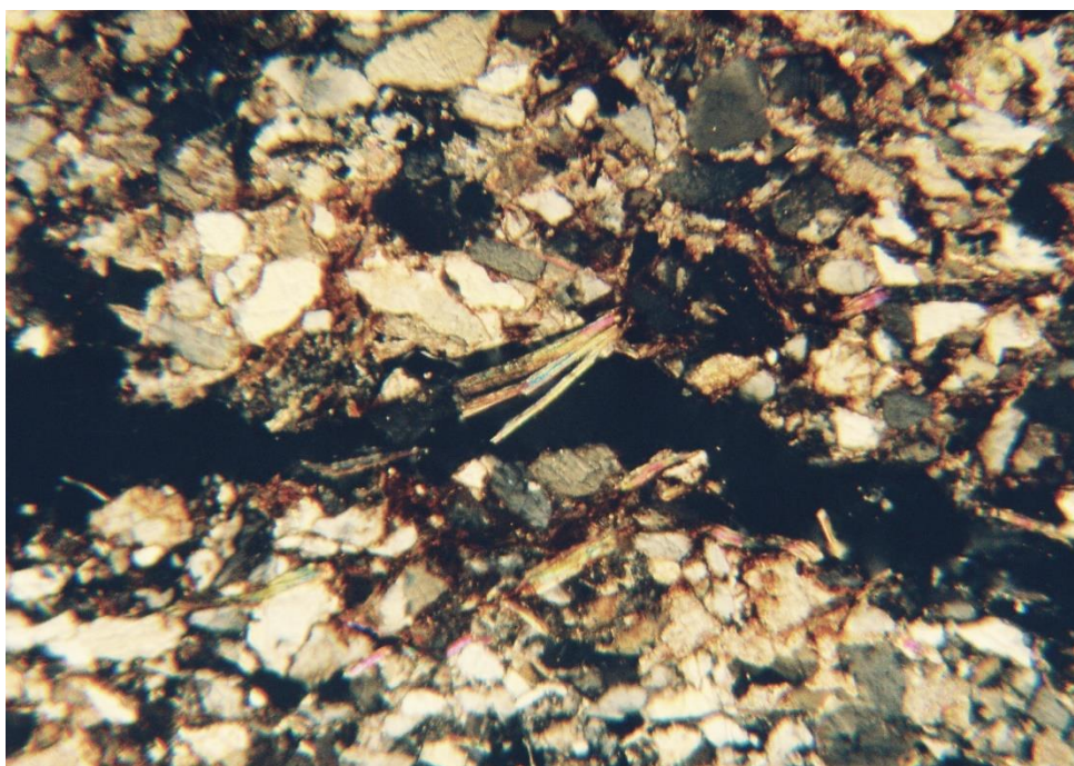
Pískovec křemenný, prachovitý, slídnatý, hematitizovaný vzorek ČB–1, městské opevnění, zvětšení 32x, nikoly X, dilatace strukturně odlišných poloh (zrnitostí), hematitizace
