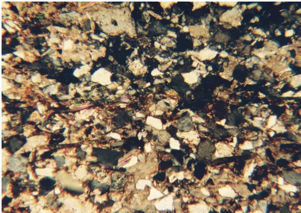
Pískovec křemenný, prachovitý, slídnatý, hematitizovaný vzorek ČB–1, městské opevnění, zvětšení 32x, nikoly X, sílící projevy hematitizace směrem do prachovitého podloží
