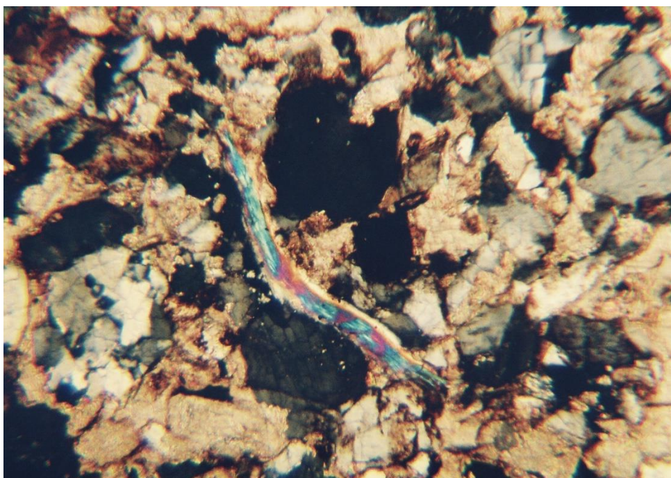
Pískovec křemenný, prachovitý, slídnatý, hematitizovaný vzorek ČB–1, městské opevnění, zvětšení 63x, nikoly X, lokální kalcifikace (?) IKP, deformovaný muskovit
