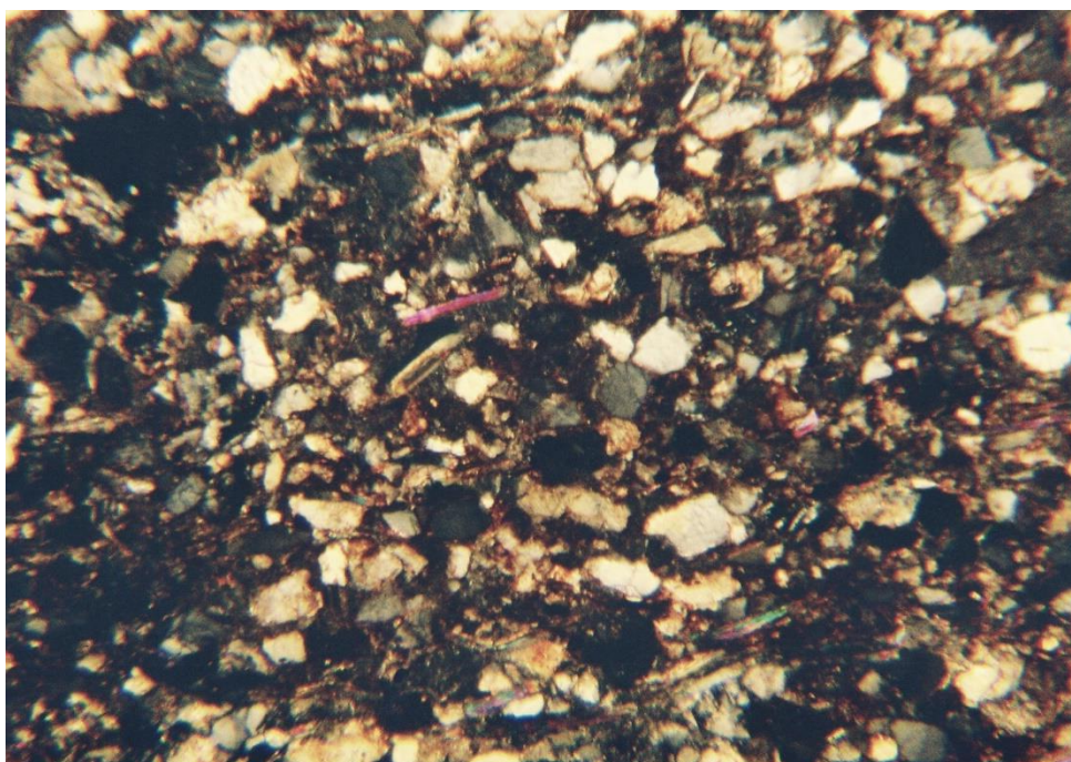
Pískovec křemenný, prachovitý, slídnatý, hematitizovaný vzorek ČB–1, městské opevnění, zvětšení 32x, nikoly X, rozhraní slabé (nadloží) a silné (podloží) hematitizace, struktury
