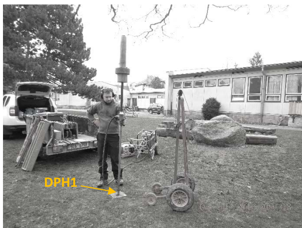
Obr. 1,2: provádění sondy DPH1 v pohledu k jihu; provádění sondy DPH2 v pohledu k severu.
