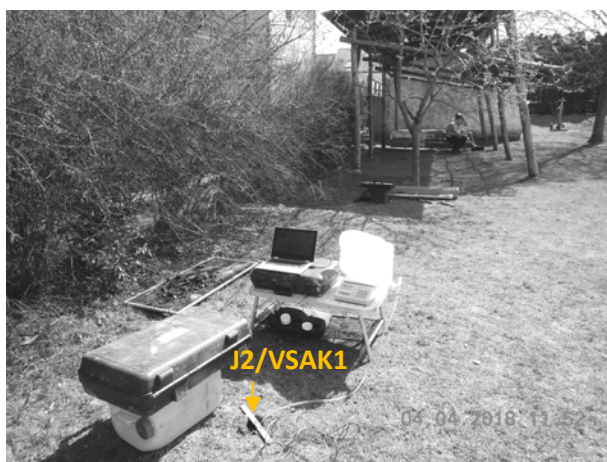
Obr. 3,4: Probíhající vsakovací zkouška v sondě J2/VSAK2 pohledu k jihu; odřez svahu v blízkosti sondy J3 pohled k SZ.
