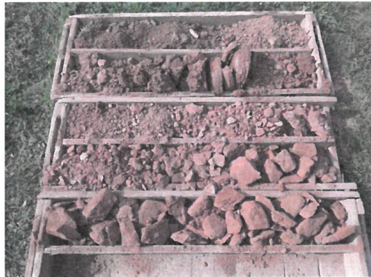
ČESKÝ BROD - P.Č. 996/2 a 996/3: VLEVO – HLOUBENÍ VRTU J-1, VPRAVO – VRTNÉ JÁDRO VRTU J-1
