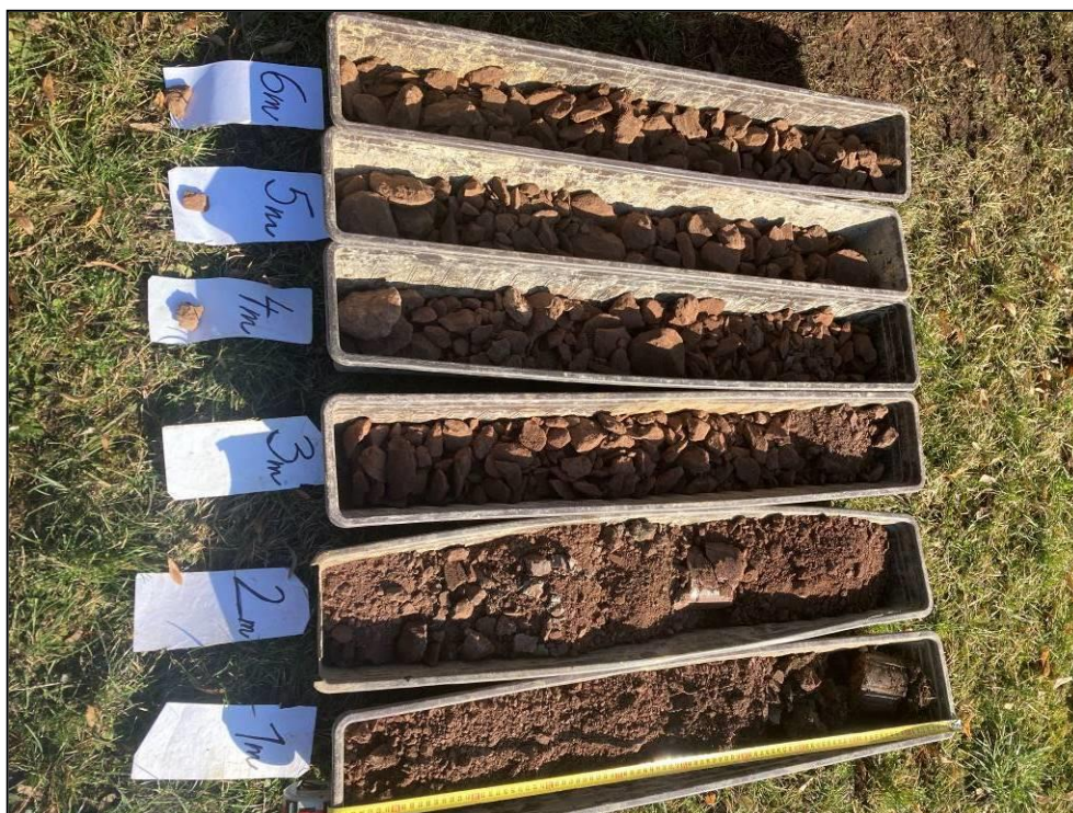
Obrázek č. 6: Fotodokumentace vrtného jádra J-3
