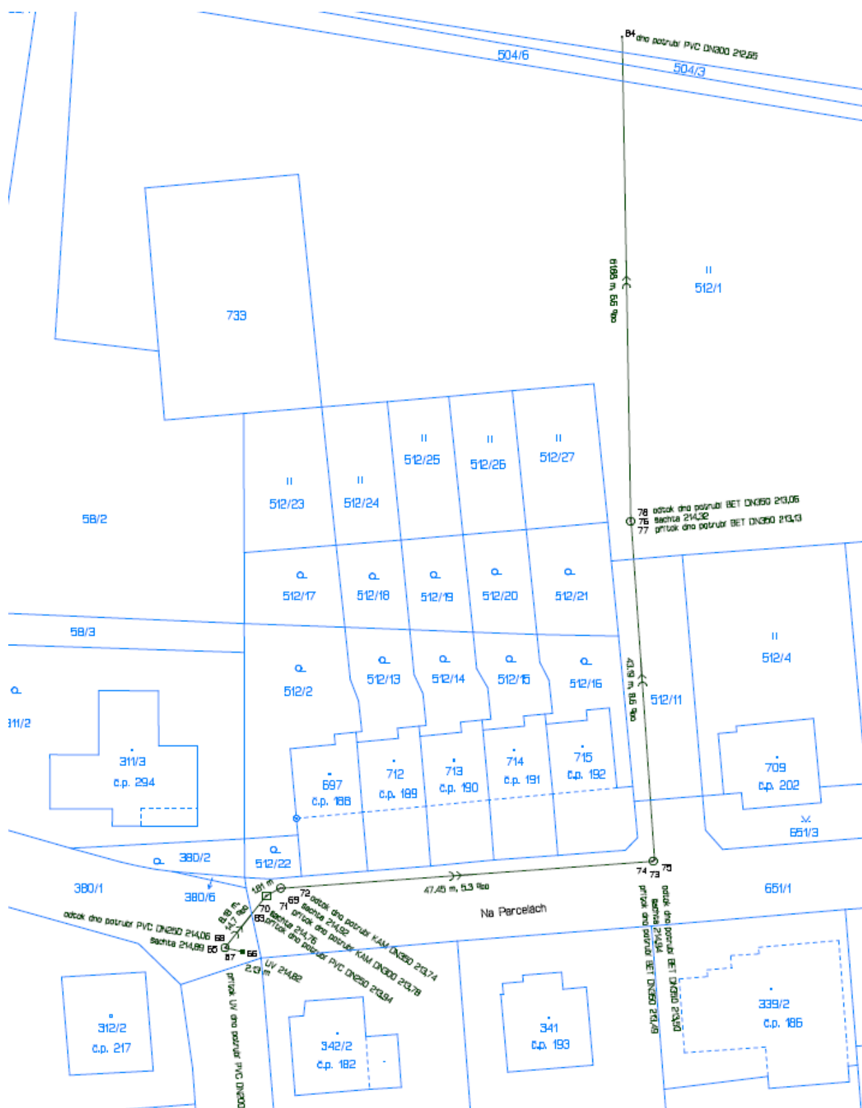
Obrázek 10 Geodetické zaměření dešťové kanalizace
