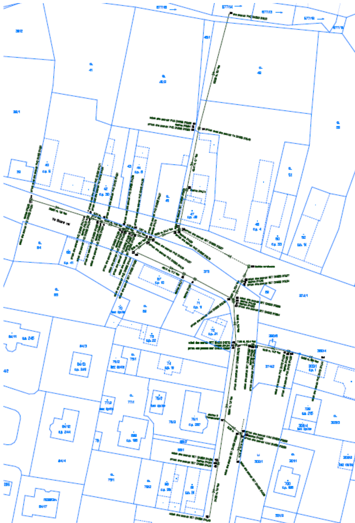
Obrázek 15 Geodetické zaměření dešťové kanalizace
