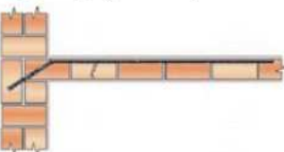
7 Opravy trhlin v blízkosti rohů a otvorů
