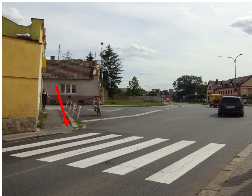
Obr. 17: Nárožní obruby „utopená“ pod povrchem vozovky
