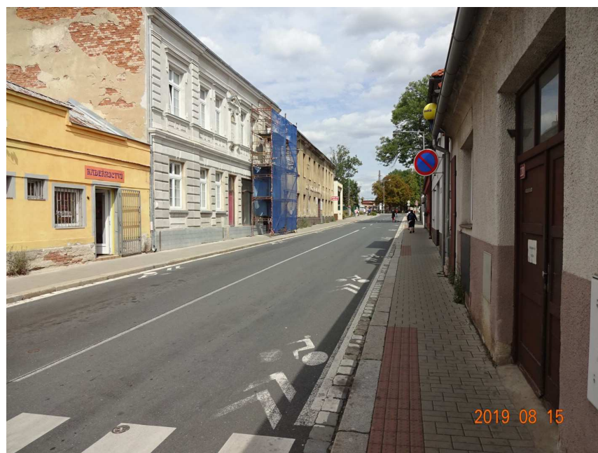
Obr. 16: Chodník šířky 1,25 m nezaručuje bezpečný komfort pohybu pěších
